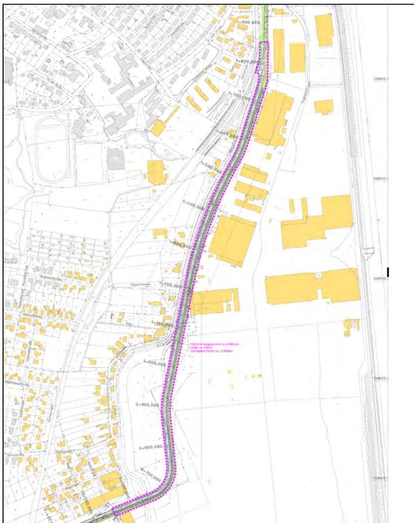
Die Straße wird komplett im Tiefbau neu hergestellt. Die Fahrbahn folgt der alten Deichlinie. Die Fahrbahnbreite soll 7,0 m inkl. Randstreifen und Markierung betragen. Hinzu kommen Flächen für Bankett, Entwässerung, Geh- und Radwege und ggf. Lärmschutzwände (LSW), so dass sich eine maximale Ausbaubreite von 16,25 m ergibt. Die Fahrbahnoberfläche soll asphaltiert werden.
