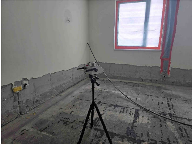
Abb. 15 + 16: Schlaf-/Therapieraum – EG-26/27: Sowohl an der Innenwand als auch an der Außenwand sind feuchte Stellen nachweisbar (hier 135,7 digits). Die Wände sind aber nicht durchgängig feucht.
