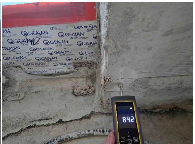
Abb. 13 + 14: Flur – EG-14: Die Werte schwanken von Wandabschnitt zu Wandabschnitt von sehr feucht bis leicht feucht (hier 138,0 und 89,2 digits).
