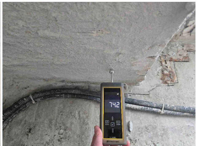
Abb. 5 + 6: Bewegungsraum – EG-13: Mit 116,9 digits ist die Wand weiterhin feucht (Bild links). 74,2 digits bedeuten leicht erhöhte Feuchtigkeit in der Wandoberfläche, die auch durch die hohe Luftfeuchte zustande kommen kann.
