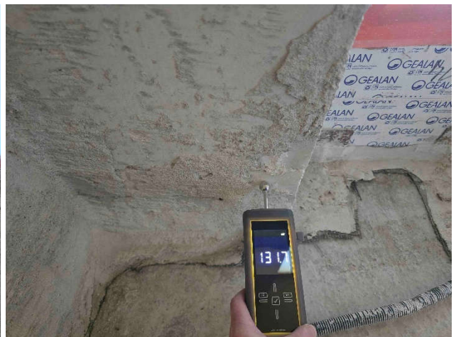
Abb. 11 + 12: Flur – EG-14: In der linken Ecke sind 131,7 digits messbar, d. h. die Wand ist noch feucht.
