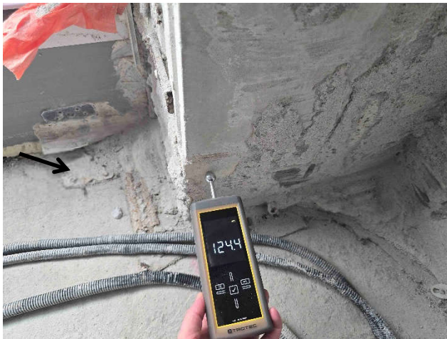
Abb. 9 + 10: Gruppenraum gelb – EG-17: Auch hier sind die Feuchtwerte besonders an der Außenwand stellenweise erhöht (hier 124,4 und 139,8 digits).
