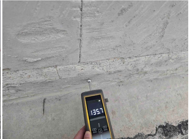
Abb. 15 + 16: Schlaf-/Therapieraum – EG-26/27: Sowohl an der Innenwand als auch an der Außenwand sind feuchte Stellen nachweisbar (hier 135,7 digits). Die Wände sind aber nicht durchgängig feucht.
